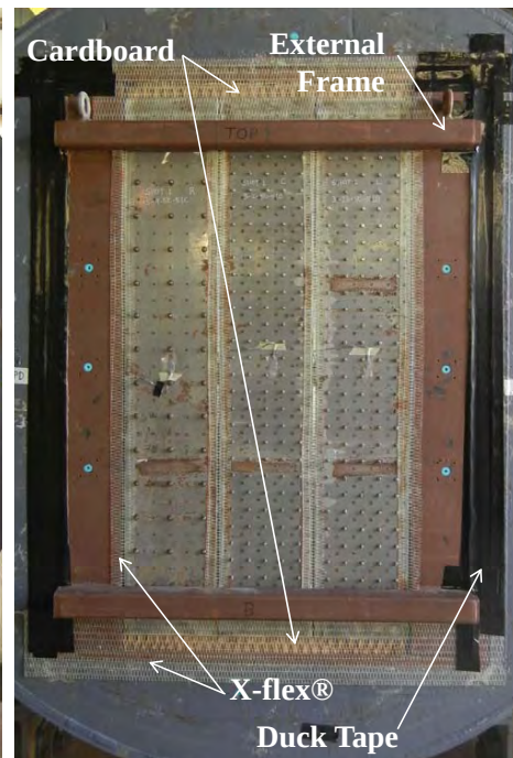
(d) Completed Setup
