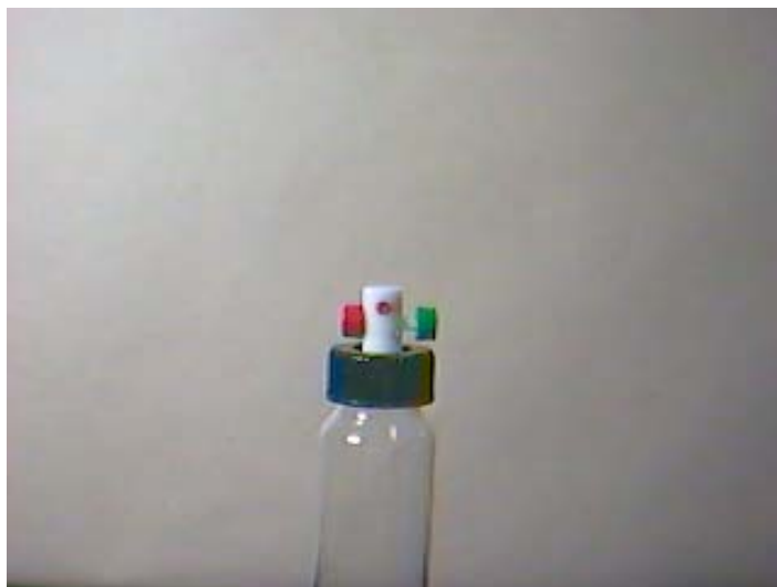
Figure 1. Sixty ml glass vial with miniert valve.
