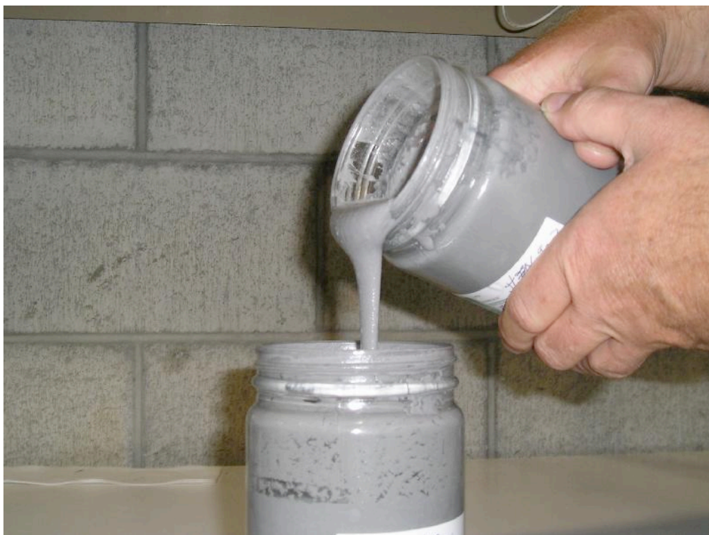
Figure 11 - Magnesium Hydride Slurry Pouring
