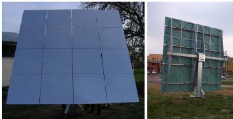
Ausgangsprodukt für die Entwicklung eines kostengünstigen Kleinheliostaten mit einer Spiegelfläche von 16 m 2 zum Einsatz in Solarturmkraftwerken.
