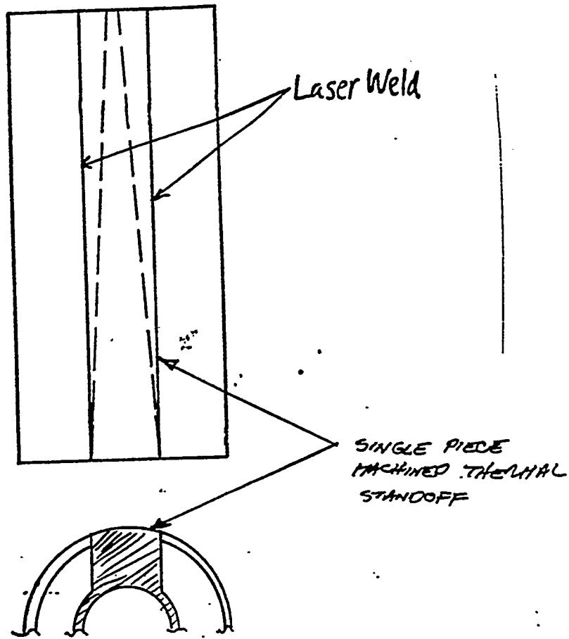
FIGURE 3 - ALTERNATIVE LONGITUDINAL FABRICATION DESIGN
