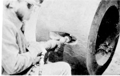
(d) GRINDING V-7B CAVITY AFTER AIR-ARC GOUGING
