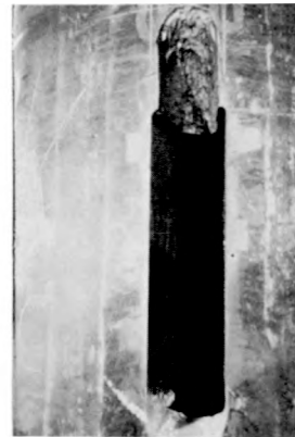
(d) LOWER (FLANGE) END - GROUND; UPPER (SHELL) END - READY FOR GRINDING
