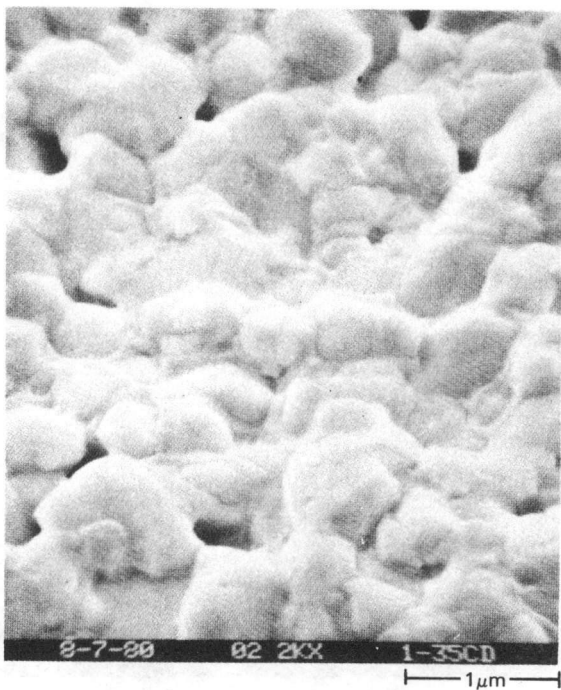
(d) 53 PERCENT \text{CdCl}_2 + \text{Cd} — 2.5\Omega\cdot\text{cm}
