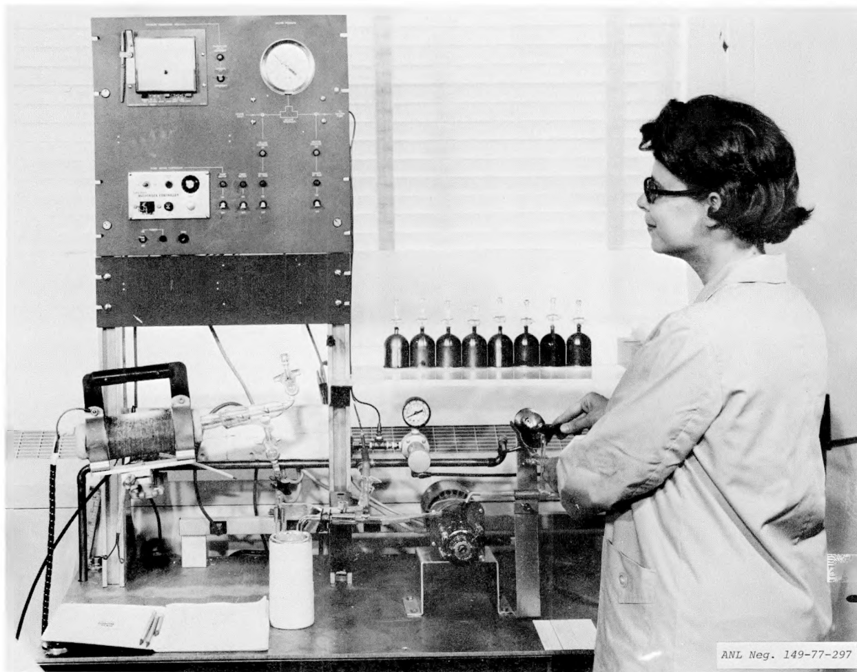
Fig. A-3. Radon Transfer System. 4
