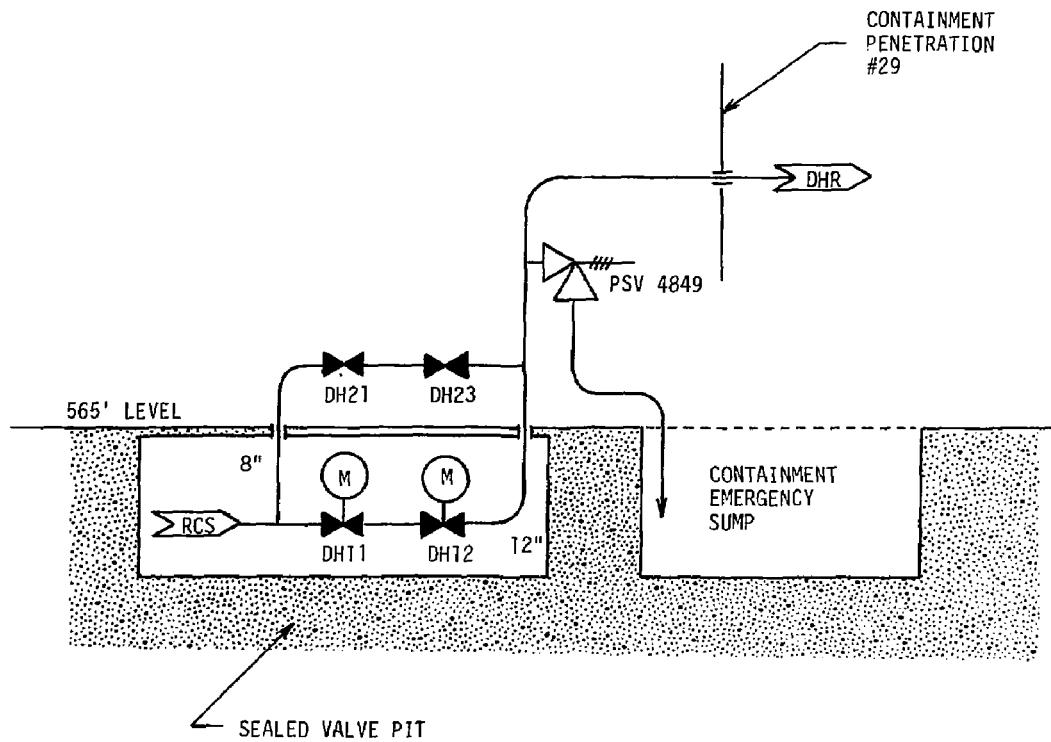
Figure 1. DHR Suction Line Diagram.
