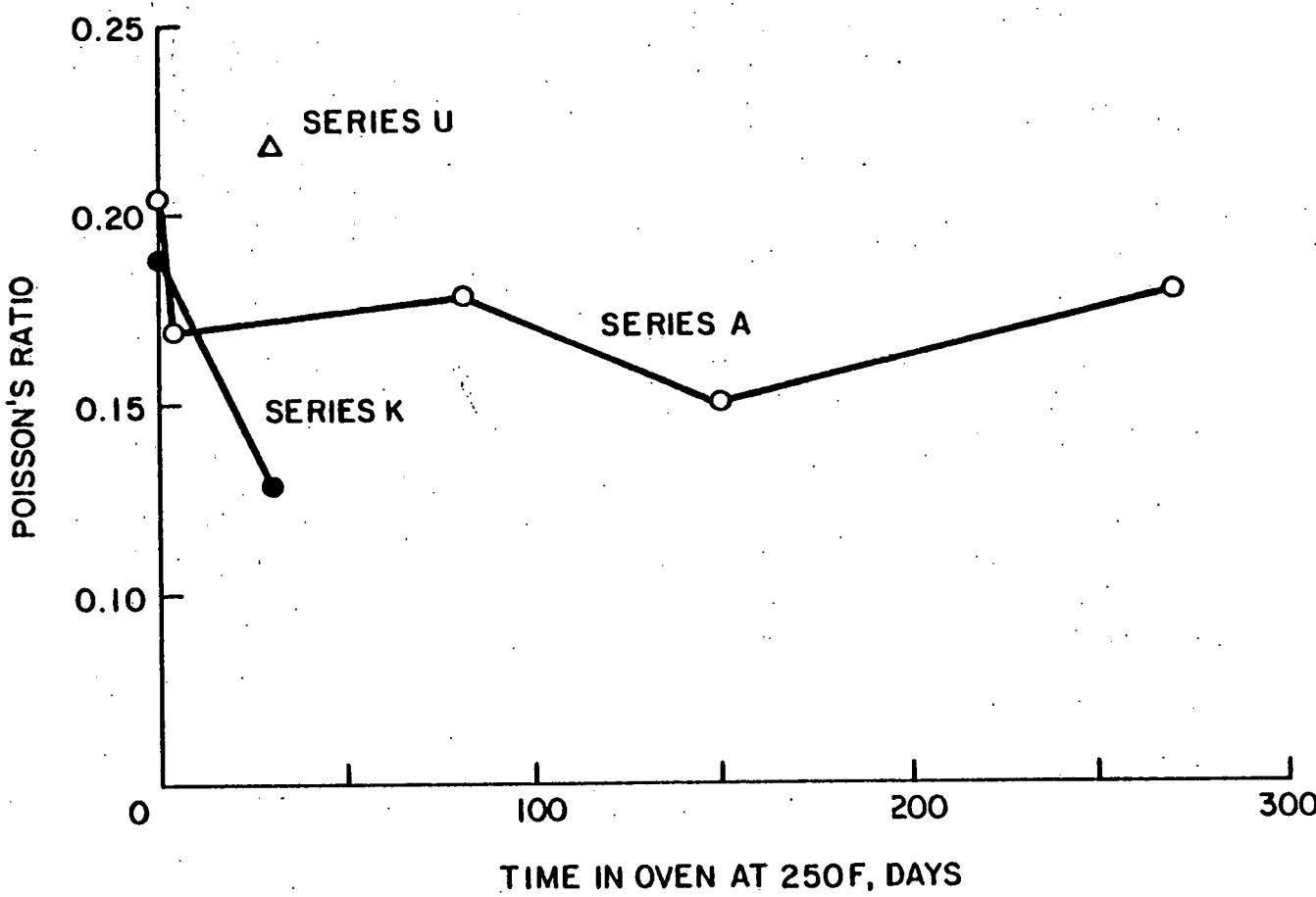
FIG. 5-POISSON'S RATIO OF 3x6-IN. CYLINDERS EXPOSED TO ELEVATED TEMPERATURE
