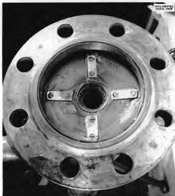
Fig. 13.2. Erosion in Pump Head; Slurry Run CS-35.
