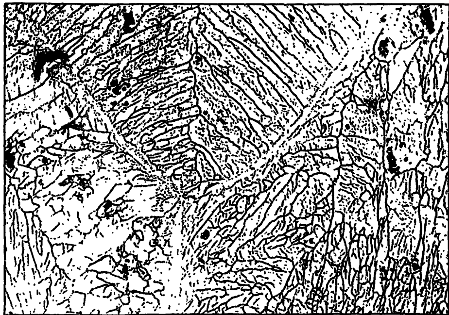
Fig. 33 - U-Cr 1,4 At. %, même traitement que les fig. précédentes. Réseau de "joints blancs". x150
