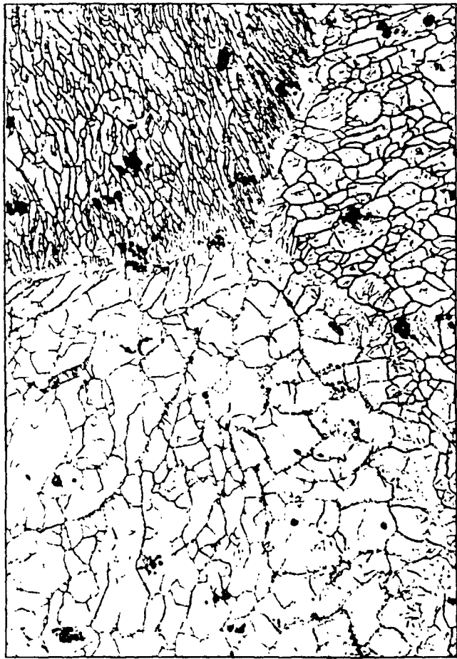
Fig. 36. Même traitement que la fig. 35. Sur une même plage, on observe à la fois la coïncidence et la non coïncidence des joints blancs avec les changements de la morphologie de la sous-structure. \times 150
