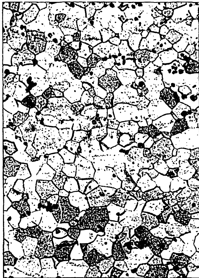
Fig. 44 - Uranium hydrogéné en \gamma , refroidi sous hydrogène puis laminé à froid et recristallisé à 600° C ( \alpha ). Pas de traces de précipité d'hydrure. x 300
