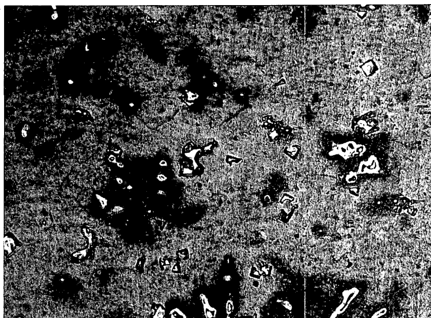
Figure 18 : Essai n°18-polissage mécanique et électrolytique, attaque chimique (250×). Le métal \gamma n'est pas décomposé, il y a de l'inhomogénéité microscopique.
