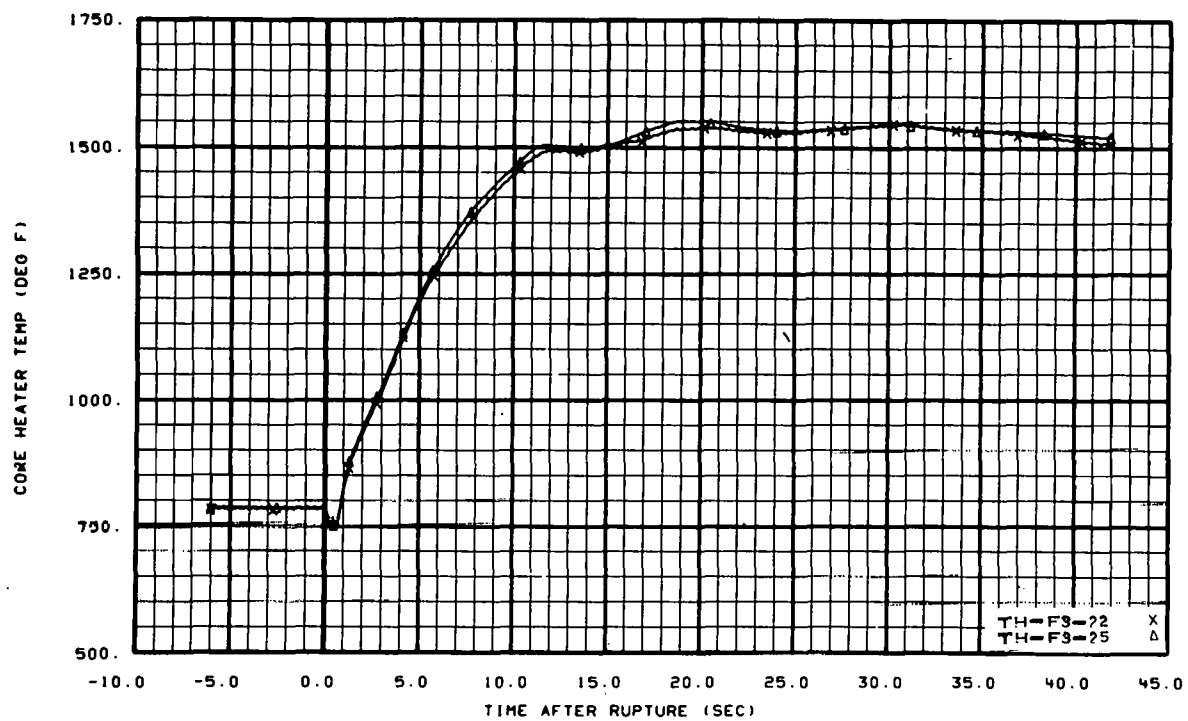
Fig. 55 Core heater temperature, Rod F-3.
