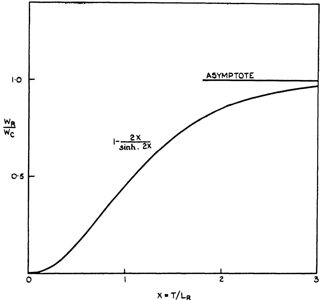
FIG. I. REFLECTOR - TO - CORE STATISTICAL WEIGHT RATIO VERSUS
