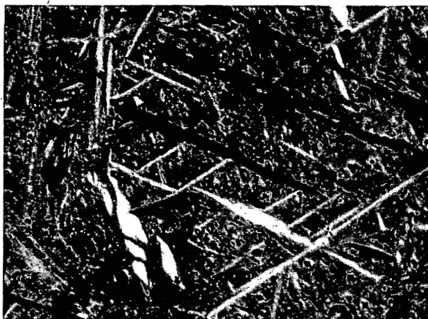
Figure 15 - Micrographie optique d'un alliage à 2,5 atomes % de niobium trempé dans l'eau depuis le domaine \gamma (vitesse de refroidissement : 600^\circ\text{C/sec.} à 750^\circ\text{C} ). Polissage électrolytique au bain acétochromique. Examen en lumière polarisée. G = \times 200 . Les aiguilles martensitiques de phase \alpha apparaissent nettement : certaines d'entre elles sont très larges.
