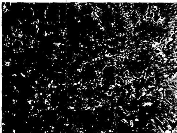
Figure 17 - Micrographie optique obtenue sur un alliage à 9,7 atomes % de niobium trempé dans l'eau depuis le domaine \gamma (vitesse de refroidissement : 600^{\circ}\text{C/sec.} à 750^{\circ}\text{C} ). Polissage électrolytique au bain acétochromique. Examen en lumière polarisée. G = \times 500 . On peut rapprocher cette structure \alpha de celle que A. G. Harding et M. B. Waldron (17) ont obtenue par trempe d'un alliage de teneur en niobium voisine et qu'ils ont désignée sous le nom de "structure de bandes parallèles".
