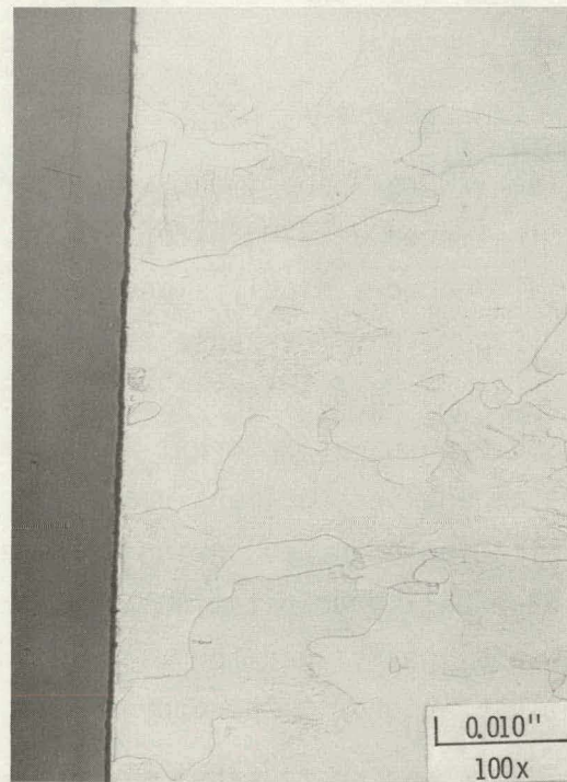
(d) High Purity ^{90}\text{SrF}_2 1100°C, 4400 Hours
