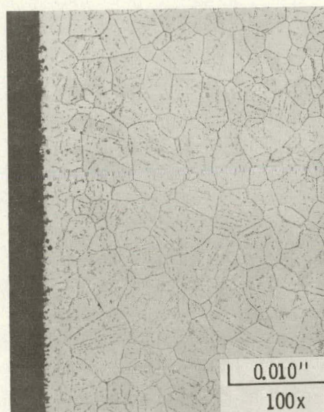
(d) Hastelloy C-276 / \text{SrF}_2 + \text{MnF}_2 (Impurity) 1000°C, 4400 Hours
