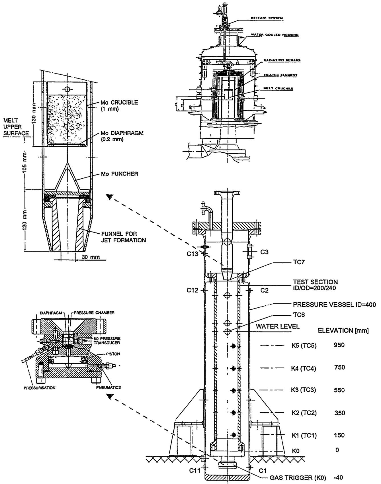
Fig. 2.1 KROTOS Test Facility
