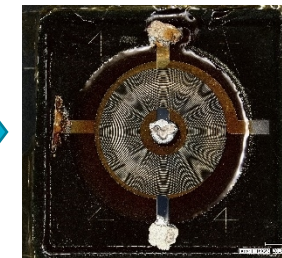
Secondary Layer 2 (Ag, Cu, Ni) Plasma + AJP + ECD
