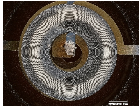
Secondary Layer 1 (Ag, Cu, Ni) Plasma + AJP + ECD
