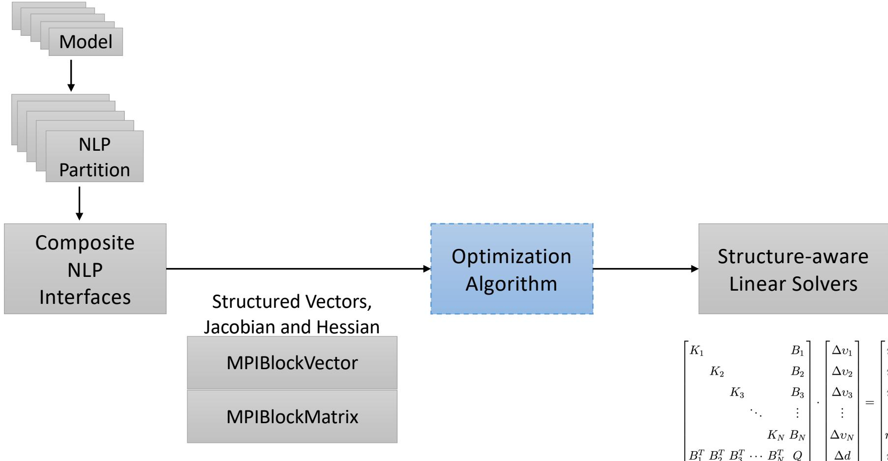
$$\begin{bmatrix} K_1 & & B_1 \\ & K_2 & B_2 \\ & & K_3 \\ & & & \ddots \\ & & & & K_N & B_N \\ B_1^T & B_2^T & B_3^T & \cdots & B_N^T & Q \end{bmatrix} \cdot \begin{bmatrix} \Delta v_1 \\ \Delta v_2 \\ \Delta v_3 \\ \vdots \\ \Delta v_N \\ \Delta d \end{bmatrix} = \begin{bmatrix} r_1 \\ r_2 \\ r_3 \\ \vdots \\ r_N \\ r_d \end{bmatrix}$$
