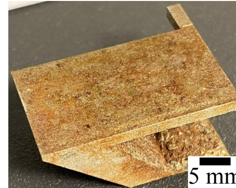
SLM®280 As-cut wire EDM
