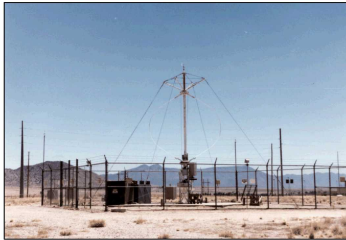
Figure 2. Sandia National Labs 5-meter VAWT (Berg, 2016).
