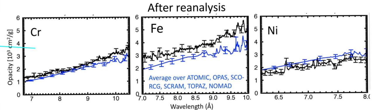
Anchor2:  $T_e \sim 184 \text{ eV}$ ,  $n_e \sim 3 \times 10^{22} \text{ cm}^{-3}$
