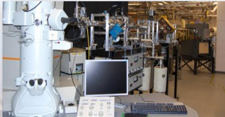
In situ Ion Irradiation TEM (I 3 TEM)
