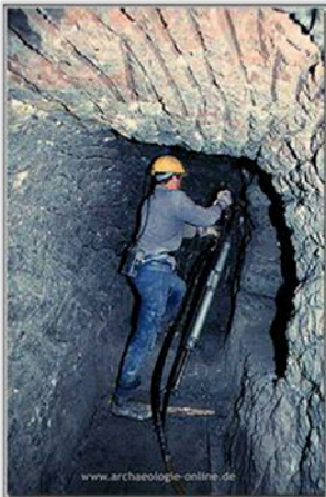
Vortriebsarbeiten mit dem Preß- lufthammer in zukonvergierten Alt- Strecken im Dürnberger Salz- bergwerk (A)
