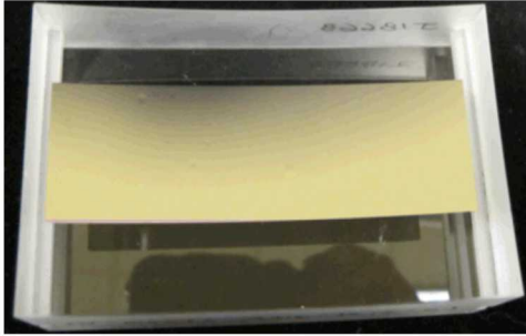
XRS3 -Spherically-bent Ge (Sandia)
