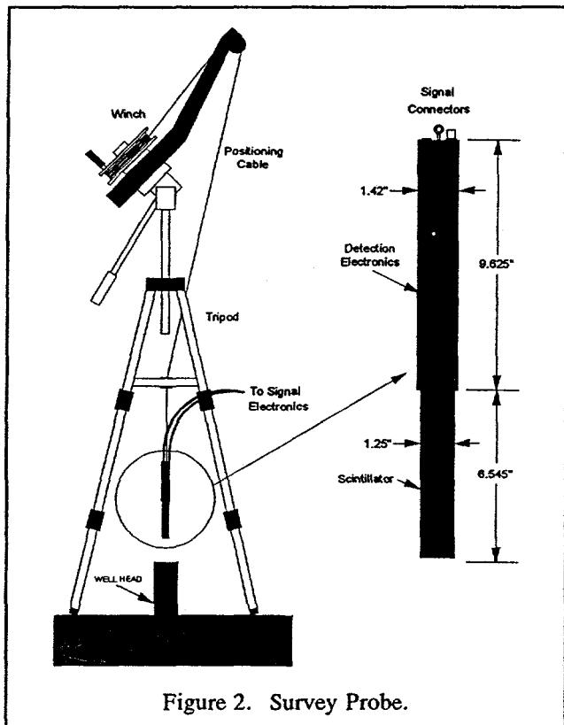
Figure 2. Survey Probe.
