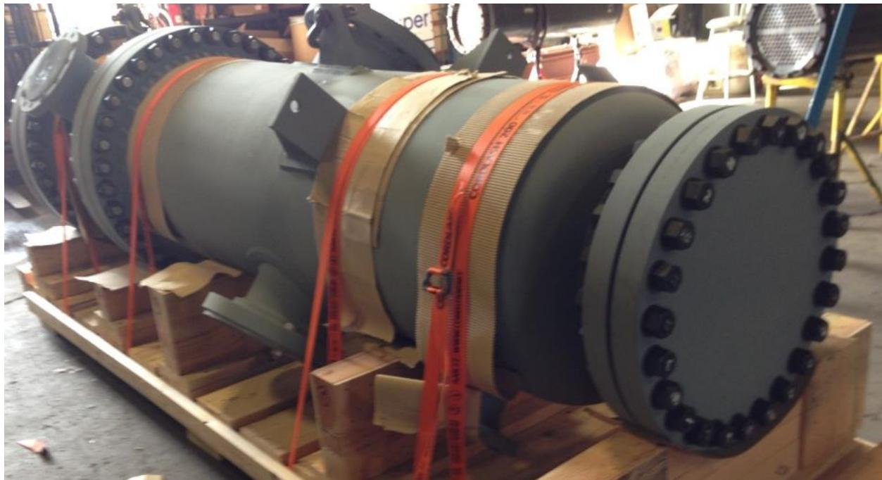
*Figure 5.1-6. HEX 2 Pressure Vessel*
