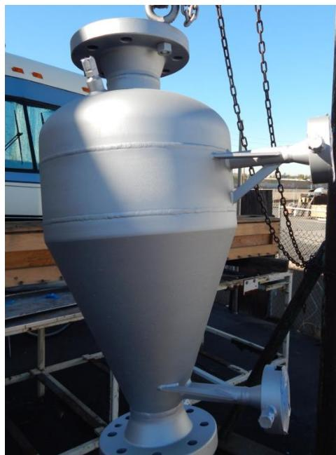
*Figure 5.1-5. Fly Ash Lock Hopper Vessel*
