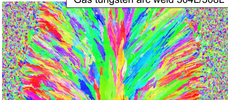
Gas tungsten arc weld 304L/308L
