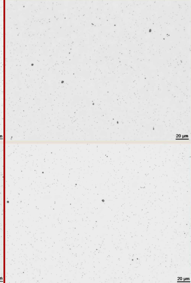
HIP (15 ksi, 1093°C, 6 hrs) + ambient pressure 1200°C, 2 hrs
