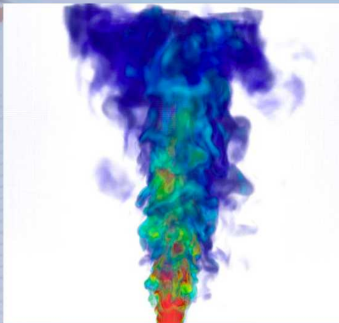
Re 6600 turbulent jet using SIERRA Fuego
