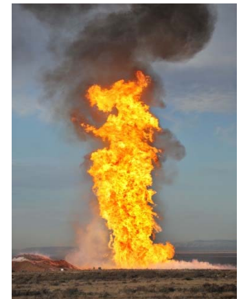
83 m diameter LNG pool fire on water (SNL)
