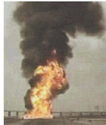
35 m diameter LNG pool fire on land (Montoir Tests)
