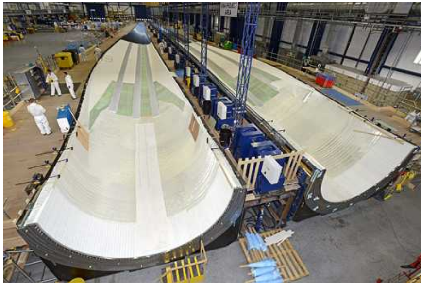
Vestas turbine blade mold (MIT Tech Review)
