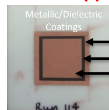
Cu bottom electrode BaTiO 3 film Cu top electrode
