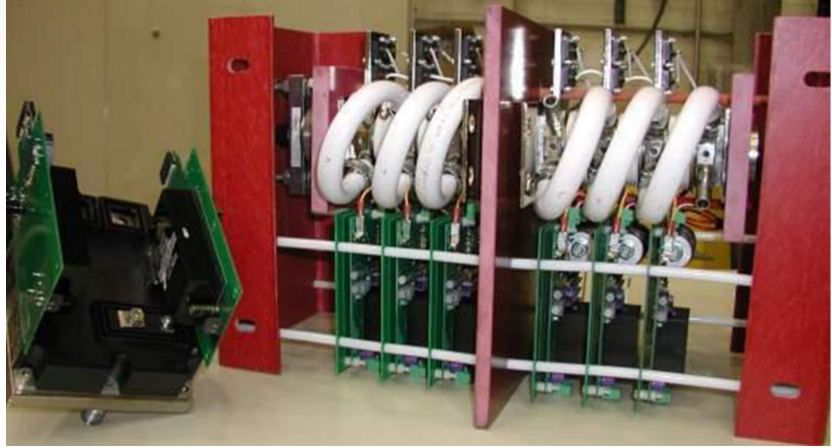
10 kV, 120 A SiC MOSFET module
