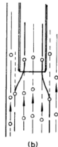
$V_{SAMPLE} > V_{STACK}$
