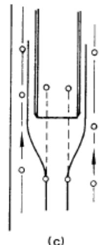
$V_{SAMPLE} < V_{STACK}$
