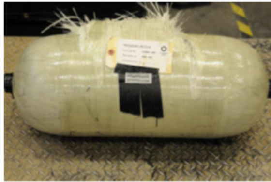
(c) COPV A-I: 80% load for 17.2 hours (d) COPV A-I: -80% load for 10.5 hours
