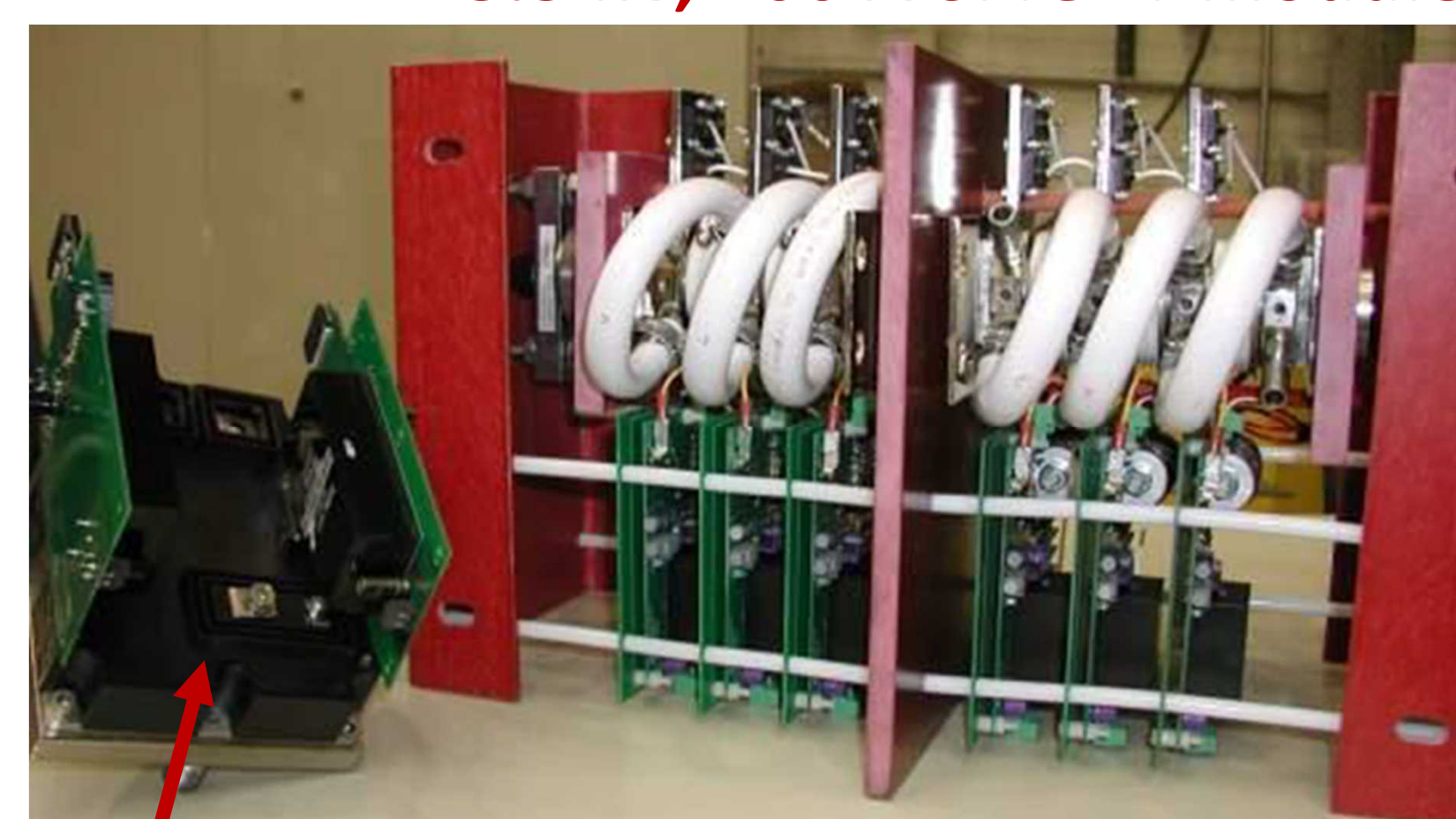
13.5 kV, 100 A Si IGBT module
