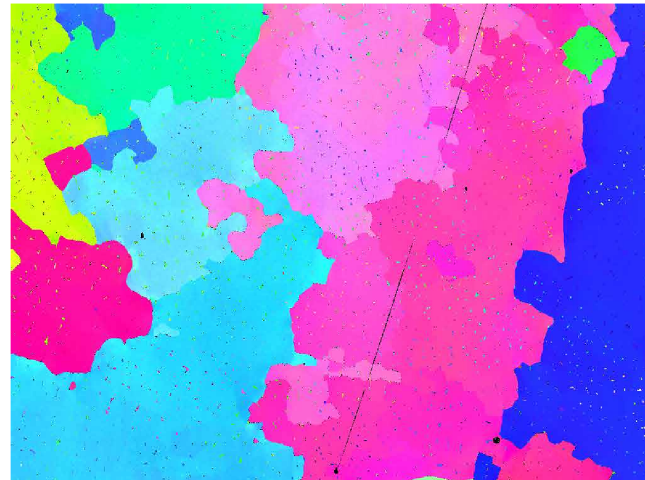
LENS 2 kW 2.3 % Ferrite/Martensite (Ferrite Scope)
