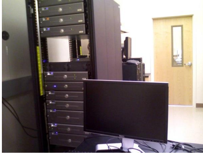
Fig. 3. UNLV web and database server, DELL Power Edge 2950 (quad-core)
