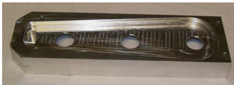
Fig. 14. Inverter flow header.
