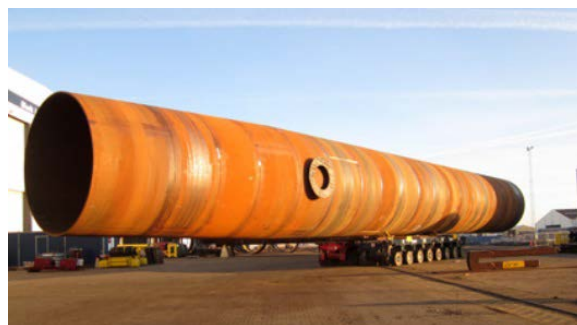
Fig. 2.6.1 Weserwind Monopile at Bremerhaven GmbH
