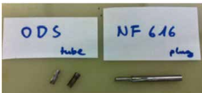
(d) ODS/NF616 welds and peel test
