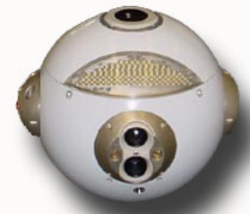
NASA - Mini AERCam 4.5 kg, 20 cm dia.
