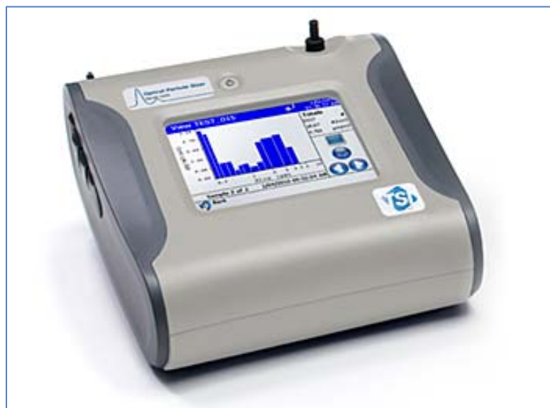
Figure 19. AI 101 Aerosol spectrometer (TSI Inc. #3330). (8” wide).
