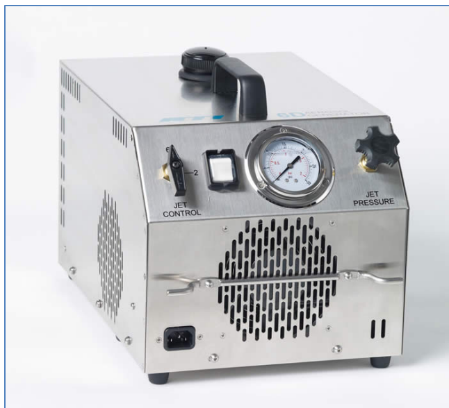
Figure 28. P105 aerosol generator ATI Inc. (LANL customized).
