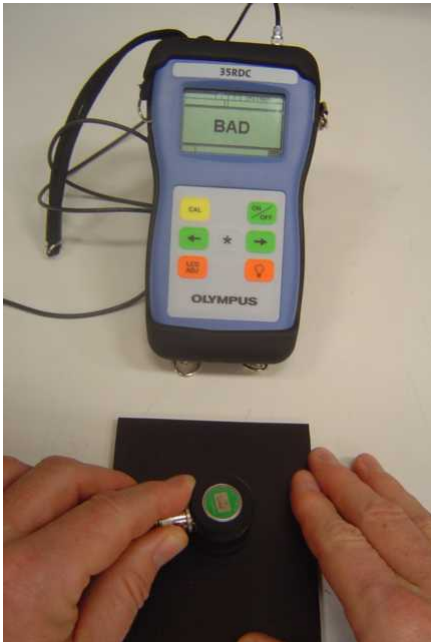
Damage Check Device (Pulse-Echo UT)
