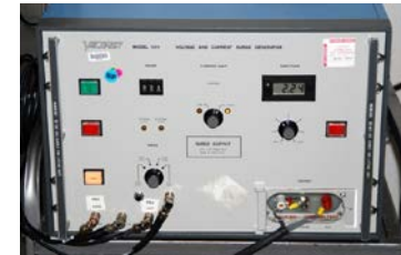
Velonex 590 I \leq 4.5 \text{ kA} V \leq 3 \text{ kV}
