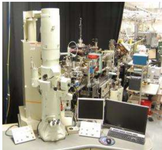
In situ Ion Irradiation TEM (I 3 TEM)
