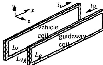
FIG. 2. INDUCTANCE MODEL OF EDS.
