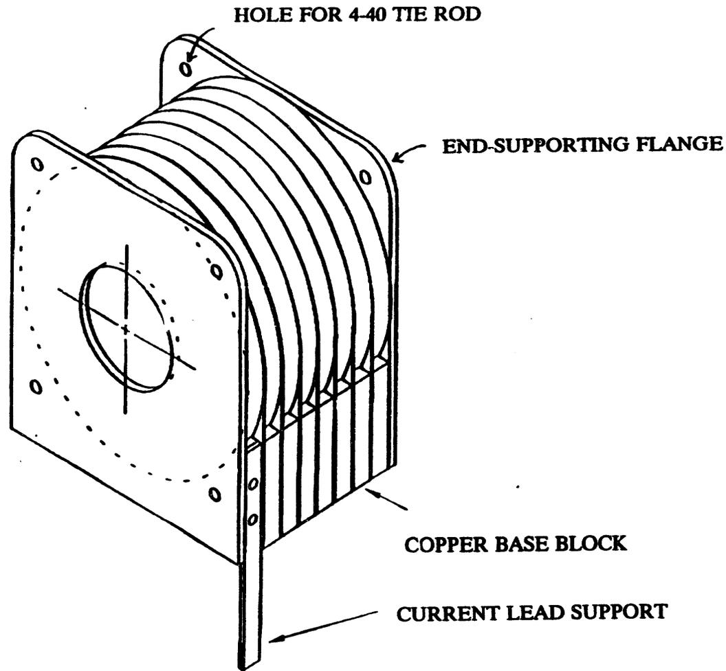
**CRYOCOOLER HIGH-T<sub>c</sub> MAGNET**
